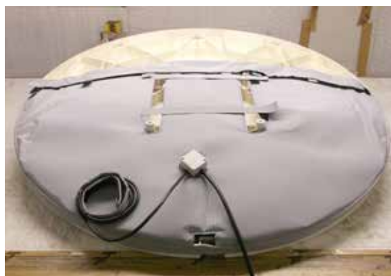
TERMOCOPERTA INSTALATA PE DISCUL ANTENEI
