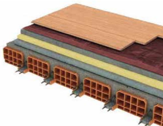
SISTEM PERSONALIZAT DE INCALZIRE MULTISTRAT INTRE SAPA AUTONIVELANTA SI PARCHET LAMINAT
