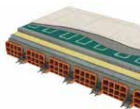
Plasa incalzitoare personalizata între sapa de beton si gresie, marmura, etc.
