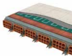
Plasa incalzitoare personalizata între pardoseala veche si cea noua
