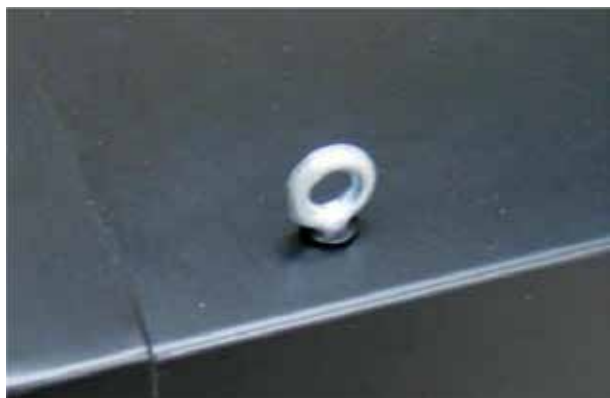
UNUL DIN CELE PATRU INELE AMPLASATE PE FIECARE COLT AL SISTEMULUI DE INCALZIRE
