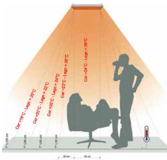
PANOU INSTALAT CU INALTIMEA DE 2,70 m, TEMPERATURA LA DIFERITE INALTIMI (TEMPERATURA ESTE DIFERITA SI DEPINDE DE TIPUL SUPRAFETEI: Cer = Ceramic tyles Legn = WOOD).
