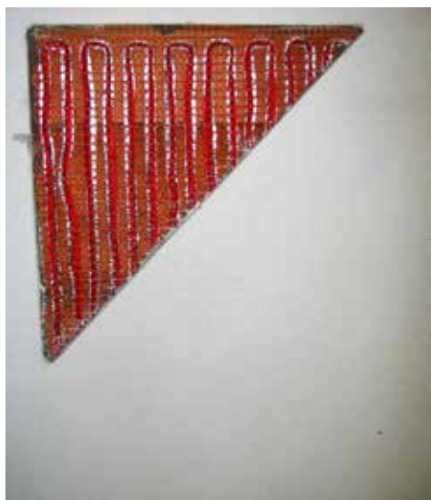
Sectiunea stratului de ipsos cu incalzire incorporata
