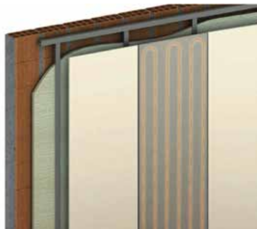
INSTALAREA PANOU RADIANT IN RAMA METALICA DEASUPRA STRATULUI IZOLATOR
